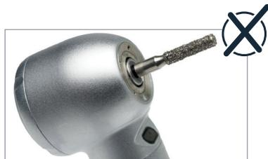
Rille im Bereich der Führungsbuchse – nicht mehr sichtbar
