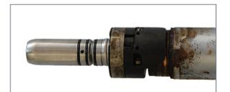
Wenn das Desinfektionsmittel in das Instrument oder in die Motor-/Turbinenkupplung läuft, können Defekte an der Kupplung und am Motor auftreten.
