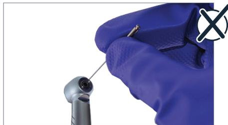
Die Reinigung der Spraydüsen durch eine von KaVo zertifizierte Reparaturwerkstatt.
