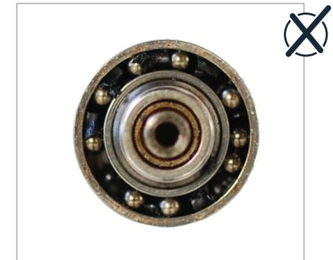
Bereits das einmalige Auslassen der Pflege, insbesondere nach einer Innenreinigung, kann zu Vorschädigungen am Kugellager führen.
