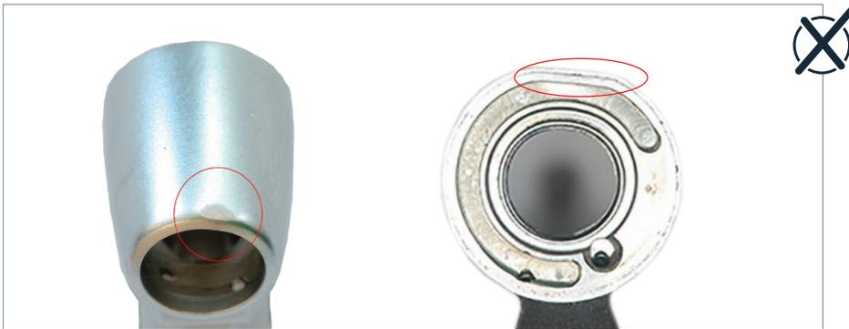
*Folgeschäden, wie das Verklemmen von Kugellagern, können thermische Schädigungen der Kugellager und somit einen schnellen Ausfall verursachen.*
