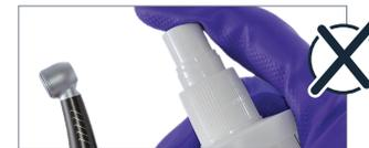
Wird zu viel oder ein nicht zugelassenes Desinfektionsmittel auf das Instrument oder die Motor-/Turbinenkupplung gesprüht, können Funktionsstörungen auftreten.
